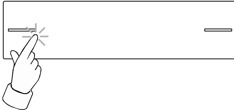
Bild 12: Wippenbedienung links (Einbaulage = Standardeinbaulage)
