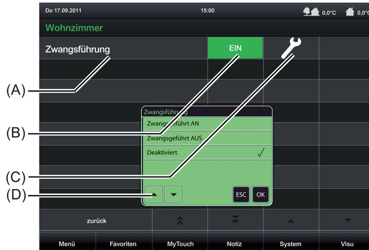
Bild 31: Beispiel für Bedien- und Anzeigeelemente der KNX Funktion "Zwangsführung"
