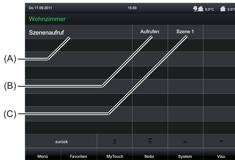
Bild 28: Beispiel für Bedien- und Anzeigeelemente der Funktion "Szenenaufruf"
