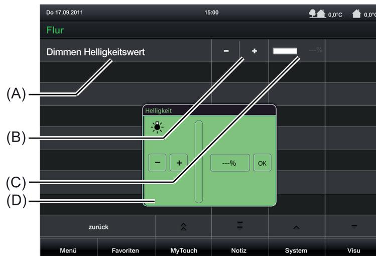
Bild 19: Beispiel für Bedien- und Anzeigeelemente der Funktion "Dimmen Helligkeitswert"
