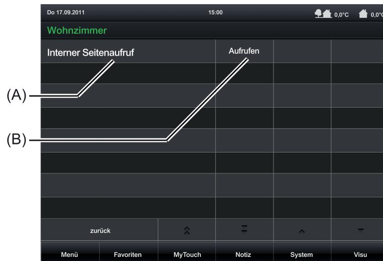
Bild 32: Beispiel für Bedienelemente der Funktion "Interner Seitenaufruf"
