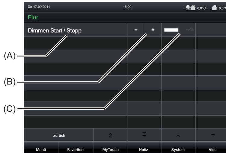
Bild 18: Beispiel für Bedien- und Anzeigeelemente der Funktion "Dimmen (Start/Stop)"
