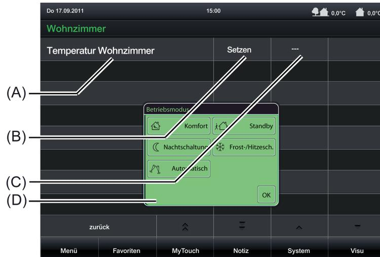
Bild 30: Beispiel für Bedien- und Anzeigeelemente der Funktion "Betriebsmodusumschaltung KNX"
