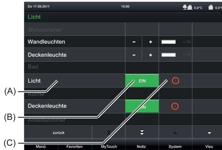
Bild 17: Beispiel für Bedien- und Anzeigeelemente der Funktion "Schalten"
