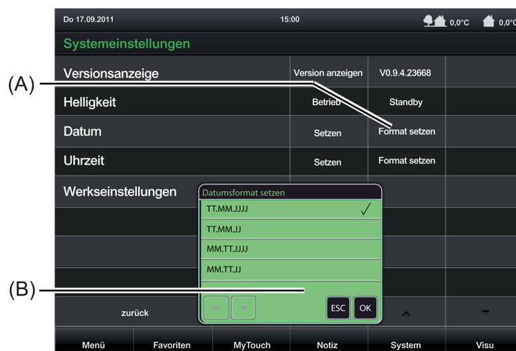
Bild 40: Menü zum Parametrieren der Datumsanzeige
