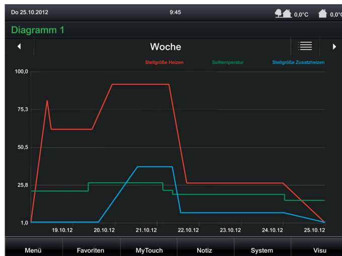
Bild 63: Beispiel eines Datenlogger-Diagramms mit 3 Kurven
