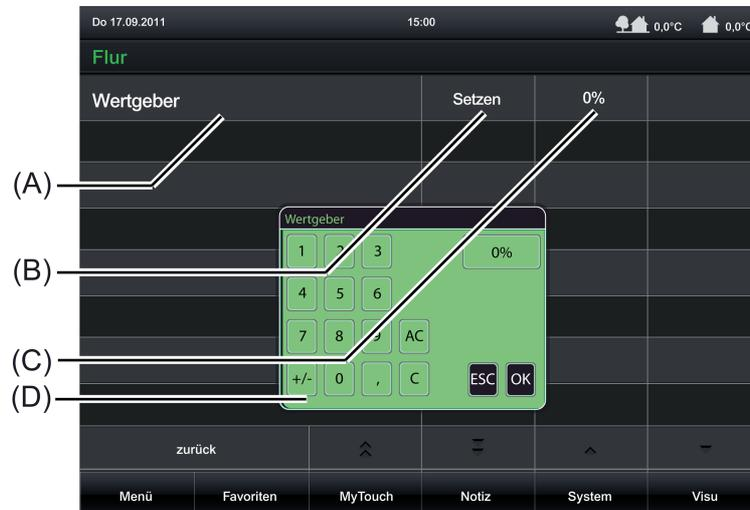
Bild 26: Beispiel für Bedien- und Anzeigeelemente der Funktion "Wertgeber" mit einem Datenformat "1 Byte 5.001...5.004"
