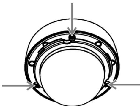
Zusätzlich kann das Kameramodul demontiert werden, um die Elektronik inklusive der Optik bei der Montage der Bodenplatte nicht zu beschädigen:
