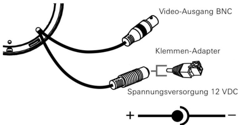
1. Die Spannungsversorgung 12 V DC entweder über den Rundstecker oder den beiliegenden Klemmen-Adapter anschließen.
