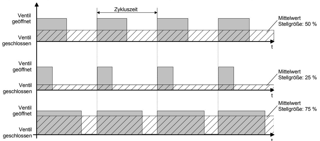
Unter Berücksichtigung des Parameters "Ventil im spannungslosen Zustand" je Ausgang werden die entsprechenden Ausgänge in Abhängigkeit der anzufahrenden Ventilstellung entweder bestromt oder nicht bestromt. Dabei wird das Tastverhältnis bei einem stromlos geöffneten Antrieb automatisch invertiert. Somit gibt es abhängig vom verwendeten Ventiltyp keine ungewollte Mittelwertverschiebung.
