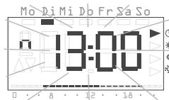
Zur besseren Zuordnung wird links oben in der Anzeige der jeweils angeführte Buchstabe dargestellt. Rechts in den vier großen Ziffern wird der entsprechende Wert angezeigt.
