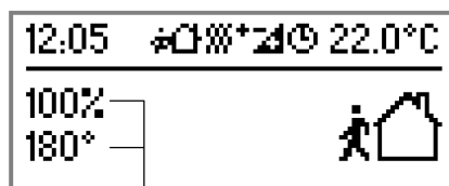
Bild 54: Beispiel einer 2-Bereichs-Anzeige mit 2-zeiliger Wertanzeige Zeile 1 Helligkeitswert, Zeile 2 Lamellenwinkel
