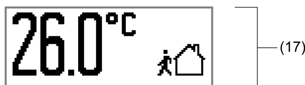
Bild 51: Beispiel für eine Grundanzeige mit einem Anzeigebereich (Raumtemperatur, Betriebsmodusanzeige)
