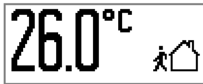
Bild 7: Beispiel für eine Grundanzeige mit einem Anzeigebereich (Raumtemperatur, Betriebsmodusanzeige)
